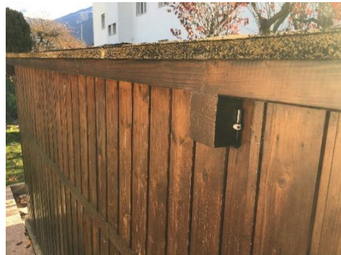
Figure 9: photographie de la serre d'hivernage avec le capteur de température de type DS18b20 pour déterminer la température extérieure.
