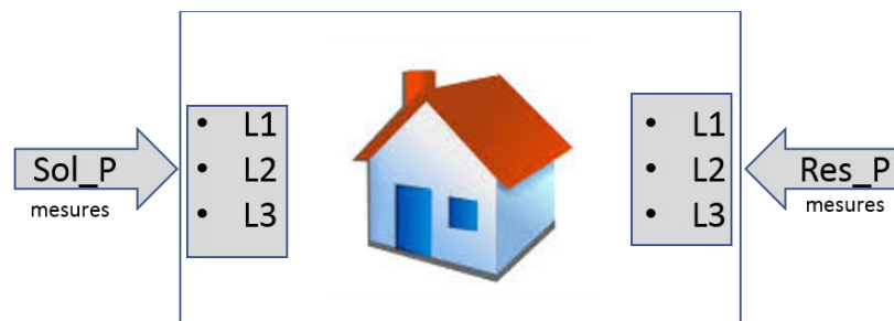
Figure 5: Mesure de la production solaire sur chacune des phases et mesure de la consommation sur chacune des phases.
